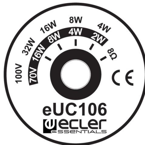
**L'eUC106 est livrée avec son sélecteur en position 70 V / 100 V. Si vous connectez accidentellement l'enceinte à une ligne basse impédance de 8  $\Omega$ , cela ne nuira pas à l'enceinte, mais cela dégradera ses performances. Si l'enceinte est réglée pour 8  $\Omega$  et est accidentellement connectée à une ligne 70 V / 100 V, elle sera sérieusement endommagée.**
