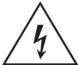
El símbolo del relámpago con una flecha en la punta y dentro de un triángulo equilátero, tiene el propósito de alertar al usuario de la presencia de un voltaje peligroso y sin aislar dentro del aparato, y de una magnitud tal que puede constituir riesgo de descarga eléctrica para las personas.
