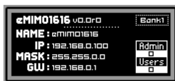
1. Configuration réseau par défaut de l'eMIMO1616
