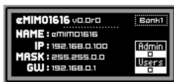
1. Configuración de red eMIMO1616 por defecto
