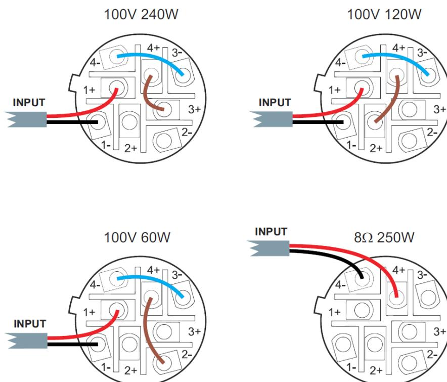
Figura 1: diagrama de conexionado del Speakon®
