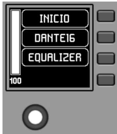
Une nouvelle pression de K2 donne accès au menu de sélection de source avec ce nouvel aspect (source sélectionnée = « DANTE16 ») :
