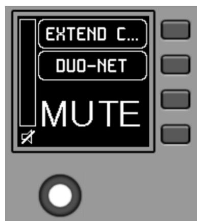
Si la fonction de contrôle de volume n'est pas activée pour le WPNETEX, tourner ou presser la commande rotative affiche temporairement un écran du type suivant, avec au centre les symboles « - - » qui clignotent :
