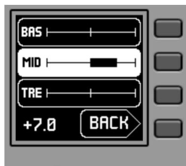
Les modifications apportées à ces paramètres sont effectuées en temps réel et ne nécessitent pas de presser K5 ni aucune autre action pour confirmer. Cependant, une longue pression de K5 (supérieure à 3 secondes) dans ce menu ramène les filtres de l'égaliseur à 0 (pas de correction).
