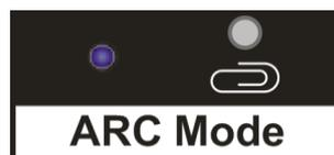
Drücken Sie die Taste mit einem spitzen Gegenstand, um den ARC-Modus zu aktivieren: die LED-Anzeige links leuchtet blau. Um den ARC-Modus zu verlassen, drücken Sie die Taste erneut. Die LED-Anzeige erlischt.
