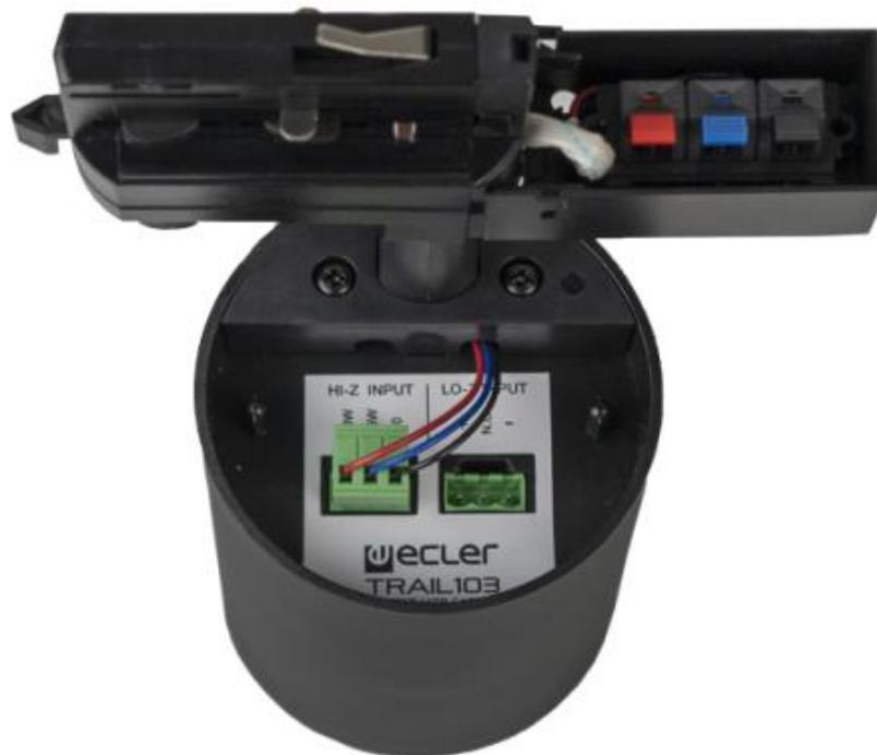
La connexion dans le haut-parleur se fait au moyen d'un connecteur mâle de type Euroblock, qui est relié à l'entrée pour haute ou basse impédance (**HI-Z INPUT** ou **LO-Z INPUT**), selon le type d'installation :
