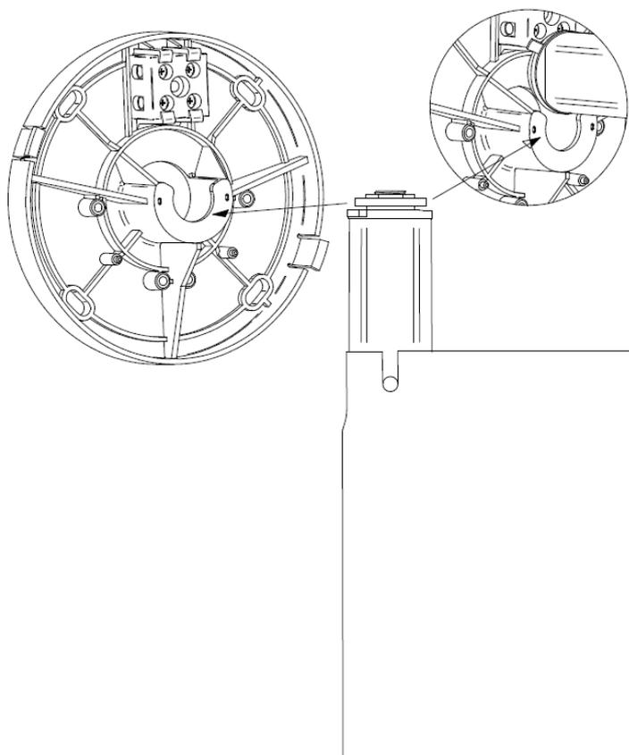
8. Fixez le cache de la base. Pour cela, pressez le cache contre la base de façon à aligner la fente et les languettes. Vous entendrez un clic une fois la fixation effectuée.
