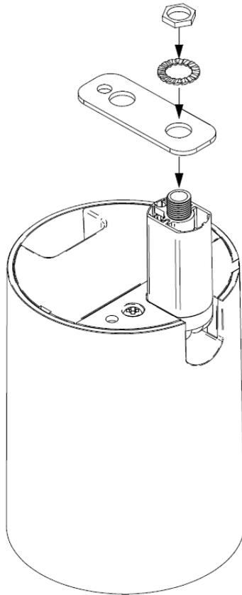
4. Effectuez les connexions en respectant pour la haute ou la basse impédance le code couleur expliqué à l'étape 3 des instructions d'installation sur rail d'éclairage. Si désiré, utilisez le rail vissable à la base de la fixation en surface. Fixez le haut-parleur à la tige filetée ou à la poutrelle et orientez-le dans la position requise sur les axes vertical et horizontal.
