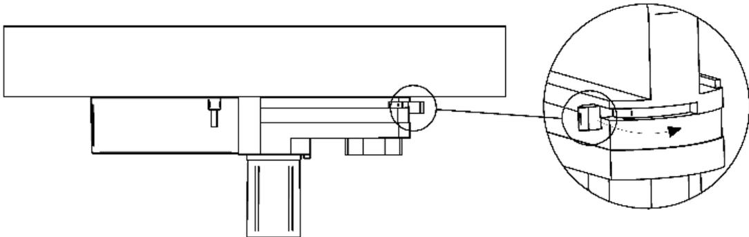
6. Oriente el altavoz hasta obtener la posición deseada en los ejes vertical y horizontal
