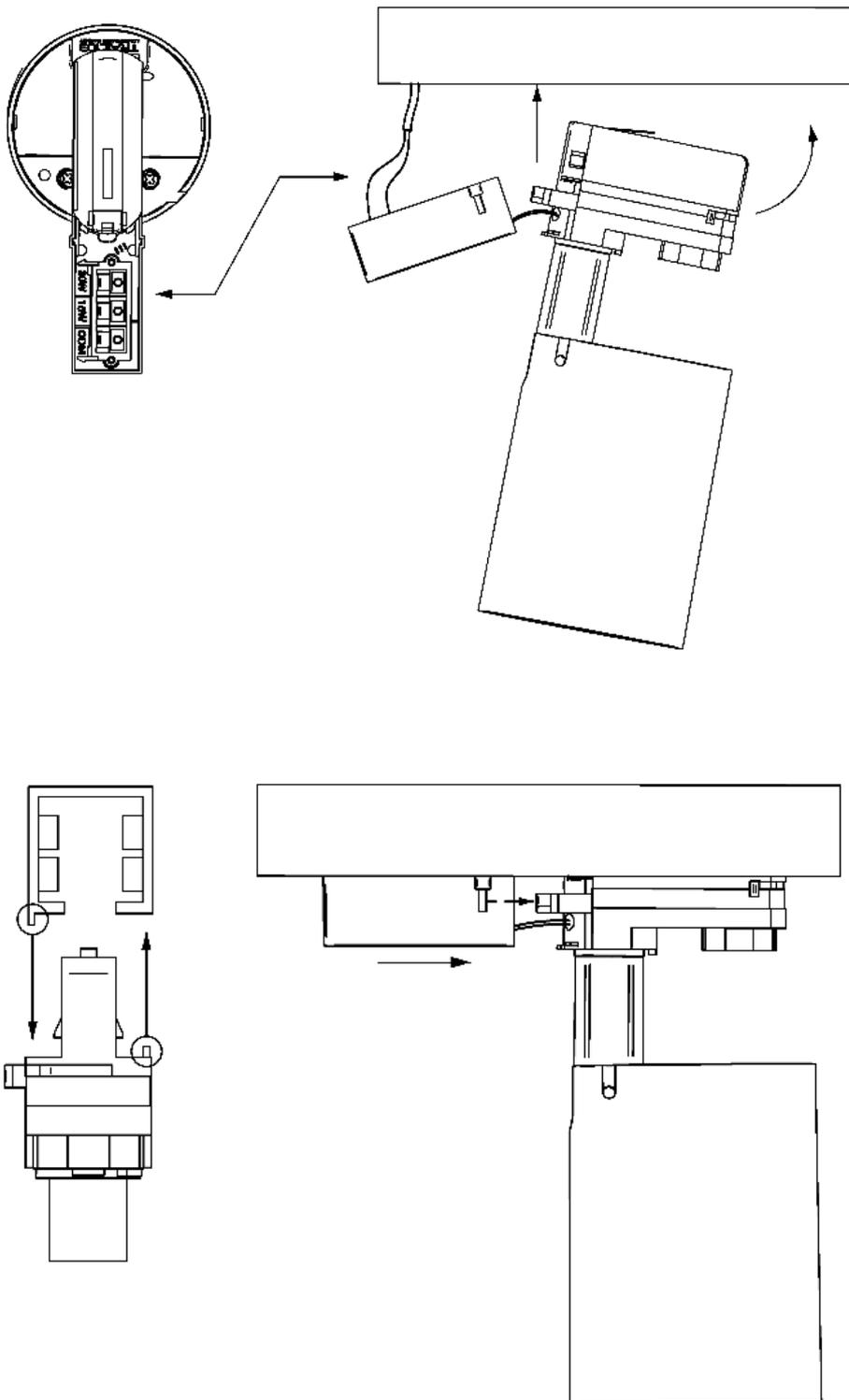
Conexión a un riel GLOBAL Trac Pro (sistema de anclaje de iluminación de tres hilos)
