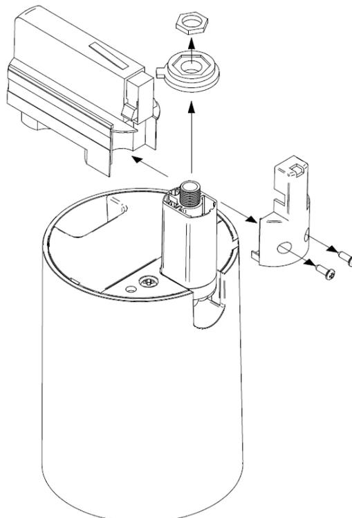
3. Fije el accesorio para el montaje en barra roscada o truss como muestra la siguiente imagen
