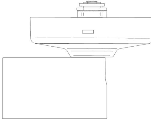
4. Fije la base del accesorio a la superficie deseada. Asegúrese de que la superficie es sólida y firme. Para ello dispone de 4 orificios. Se recomienda usar tornillos de  $\text{Ø}4\text{mm}$  (no incluidos)
