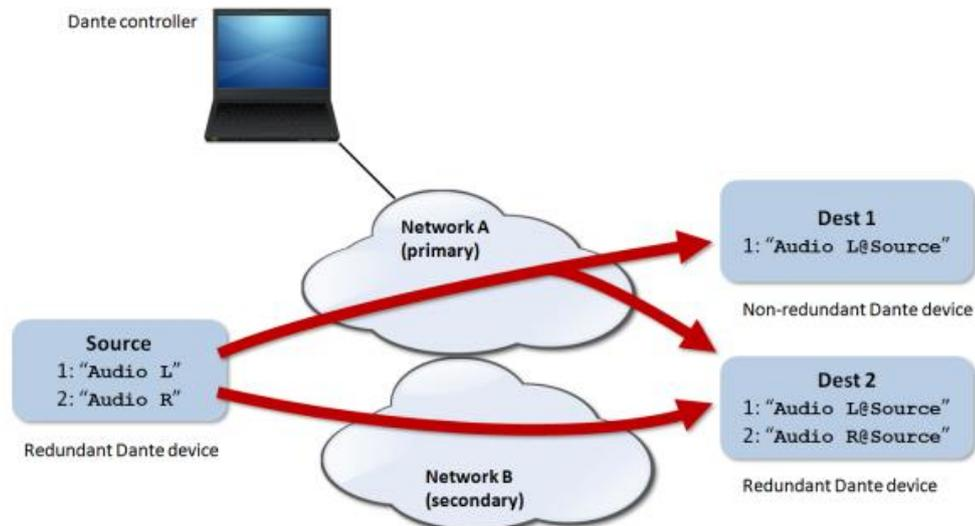
**Nota:** en este modo, si (por error) los puertos primario y secundario se conectan a la misma red Ethernet, Dante Controller dejará de disponer de acceso al control de la configuración de red y enrutamiento Dante™ de los puertos de MIMO4040DN. Dicho control se recupera al desconectar uno de ellos de la misma red en donde se encuentre el otro.
