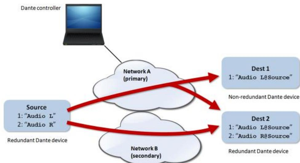
**Achtung:** Sollten in dieser Betriebsart der primäre und der sekundäre Port (versehentlich) an ein und dasselbe Ethernet-Netzwerk angeschlossen werden, so hätte die Anwendung Dante Controller keinen Zugriff mehr auf die Steuerung der Netzwerk-Konfiguration und des DANTE™/AES67-Routings der Ports der MIMO4040CDN. Der Zugriff auf die Steuerung wird wiedererlangt, sobald einer der beiden Ports von diesem Netzwerk getrennt wird.
