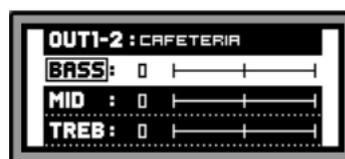
En ella, el control de tono seleccionado se indica con el recuadro parpadeante sobre el texto BASS, MID o TREBLE (graves, medios y agudos), y su ajuste se realiza mediante el giro del *encoder*:
