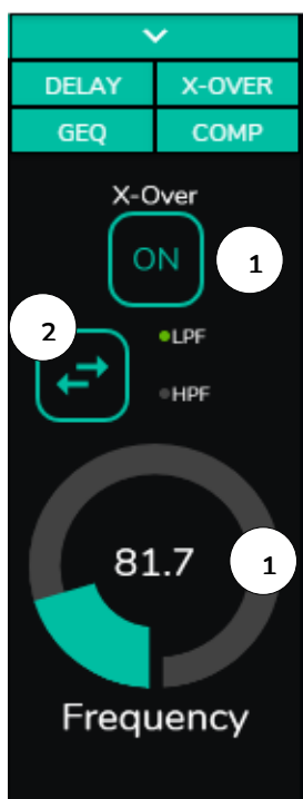
Figure 38 : réglage d'un filtre répartiteur
