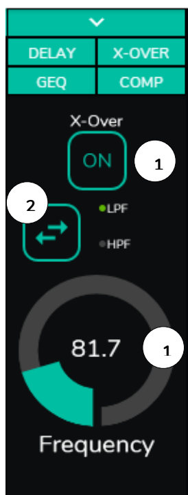
Figure 38 : réglage d'un filtre répartiteur
