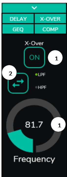
Permite introducir un filtro crossover (paso-bajos o paso-altos) en la salida seleccionada. Es independiente para cada salida. Útil si conecta a esta salida un sub-grave, por ejemplo. Disponible para las salidas de 1 a 8 en todos los dispositivos HUB.
