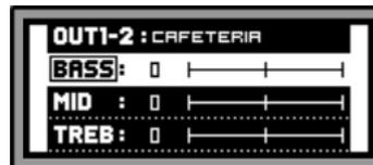
En ella, el control de tono seleccionado se indica con el recuadro parpadeante sobre el texto BASS, MID o TREBLE (graves, medios y agudos), y su ajuste se realiza mediante el giro del encoder:
