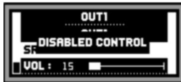
Cuando el panel frontal se encuentre totalmente bloqueado (inhabilitado) para su uso, al pulsar cualquier tecla se obtendrá el siguiente mensaje en la pantalla LCD:
