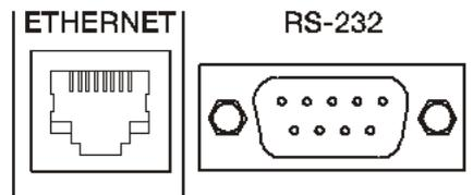
El conector ETHERNET tipo RJ45 del panel posterior permite la conexión del equipo a una red Ethernet, o bien directamente a un ordenador u otro dispositivo con interfaz Ethernet, punto a punto. Esta conexión habilita, dentro de una red local, lo siguiente:
