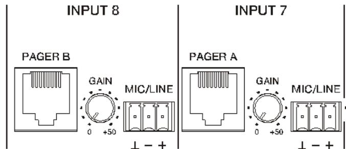
Los puertos PAGER se emplean para su conexión punto a punto a sendas estaciones de llamada tipo eMPAGE, mediante las cuales es posible realizar acciones de llamadas de voz en tiempo real (paging) a zonas de salida de la instalación, empleando un módulo de prioridad de la unidad eMIMO1616 que atenúa o enmudece totalmente el contenido sonoro de programa existente en dichas zonas en el instante de la acción.
