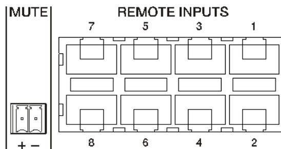
Dicha conexión física proporciona alimentación DC al panel remoto desde la unidad eMIMO1616 y establece el bus de comunicación digital entre ambos equipos. También implementa la recepción de audio mono balanceado de una potencial fuente sonora remota (conectada en el lado del panel de control) en la unidad eMIMO1616.
