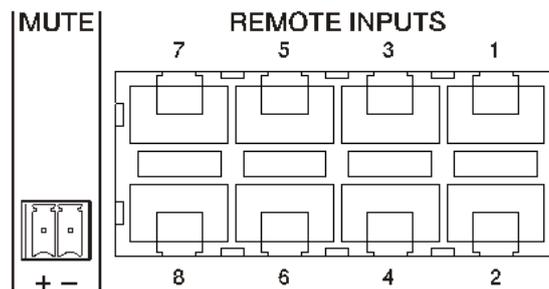
El conexionado de una señal de audio monofónica balanceada a un puerto REMOTE de la matriz eMIMO1616 se realiza de la siguiente forma:
