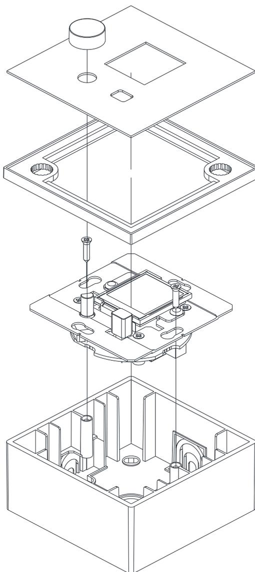
Instalación de una unidad eMCONTROL1 junto a un panel mural WPaMIX-T, sobre superficie o empotrados:
